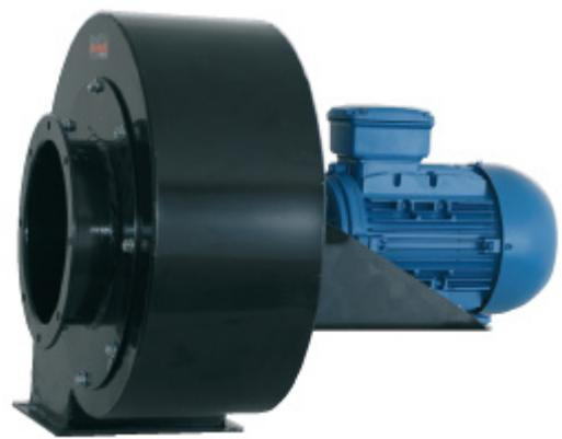
Die DRGF Rauchgasventilatoren sind für Absaugung (Unterdruck am Saugstutzen) von heißen Gasen bis zu 400 °C vorgesehen. Der Ventilator ist in jeder Achslage montierbar. Die max. Umgebungstemperatur beträgt max. 40 °C.
